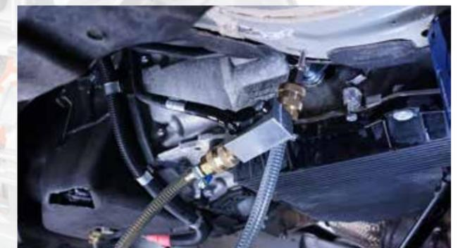
Esempio di collegamento al veicolo dei tubi olio della stazione lavacambi mediante raccordi dedicati
