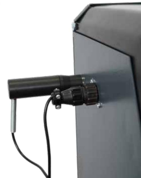
La decarbonizzazione si avvia solo a motore acceso; ponendo il sensore di vibrazione magnetico a contatto con una parte metallica del vano motore, esso ne verificherà le vibrazioni autorizzando il software a procedere.
