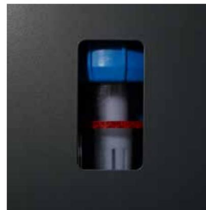
*Particolare del gorgogliatore di sicurezza interno visibile attraverso l'apertura laterale dello chassis.*
