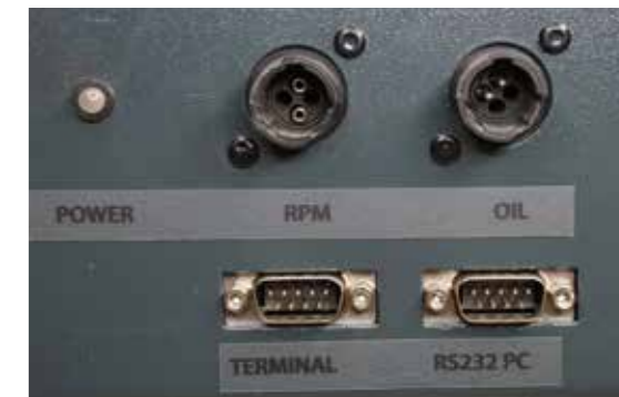
Dettaglio delle prese frontali; sopra sensore giri e temperatura, sotto collegamento al terminale ed al software
