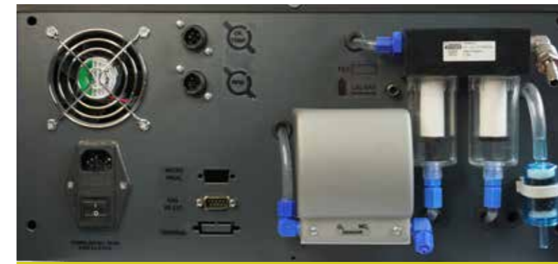
Dettaglio del retro dell'analizzatore con prese di alimentazione e connessione, filtri, tubo sonda.
