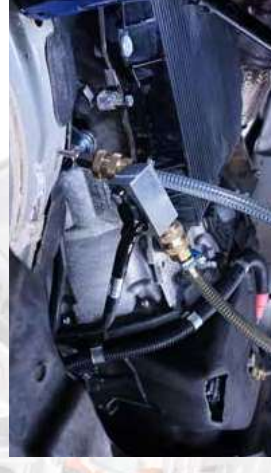
Esempio di collegamento al veicolo dei tubi olio della stazione lavacambi mediante raccordi dedicati
